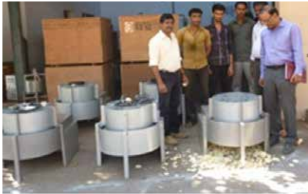
चित्र 76 : मोटर चालित कसावा चिपिंग मशीन
